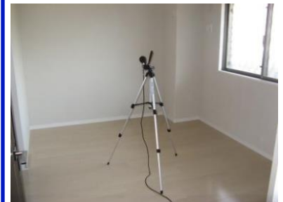
室内騒音測定状況 (防音性能確認)
